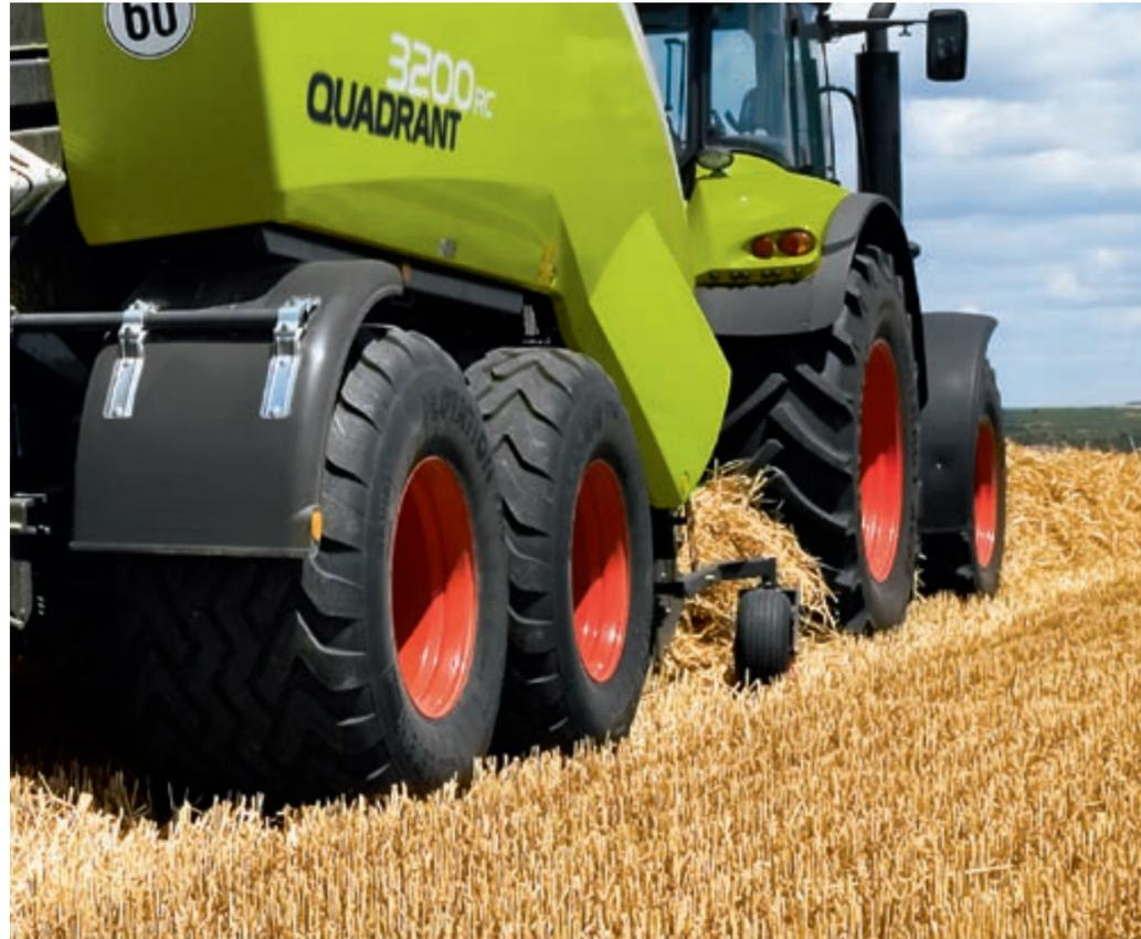
Für geringsten Bodendruck, größtmögliche Grasnarbenschonung und Laufruhe stehen Ihnen für die QUADRANT verschiedene Achsen mit unterschiedlichen großvolumigen Bereifungen zur Verfügung. Sie bieten maximale Aufstandsfläche und minimieren somit selbst auf sehr leichten oder nassen Böden schädlichen Bodendruck.
