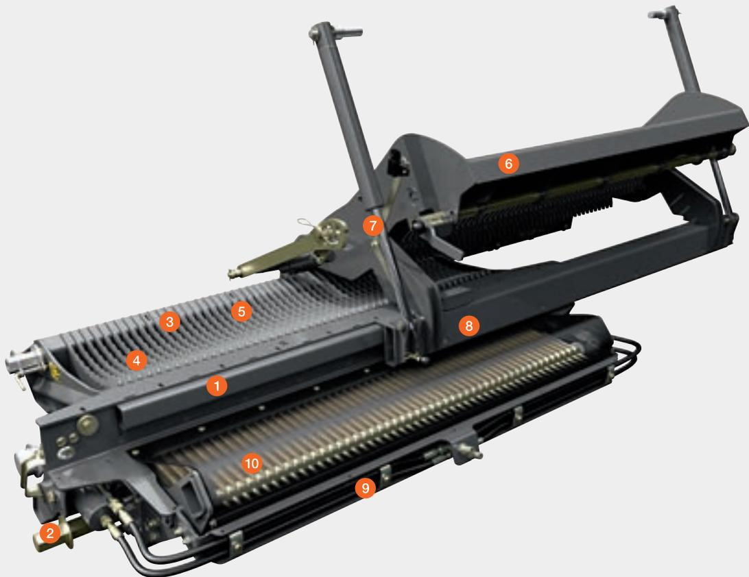
Das CLAAS Schubladensystem: Einfacher Messerwechsel, einfache Reinigung, komfortable Wartung, sichere Unterbringung der Messer.
