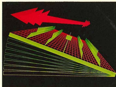
CLAAS-3-D-Reinigung Ausgleich von seitlichen Hangneigungen
