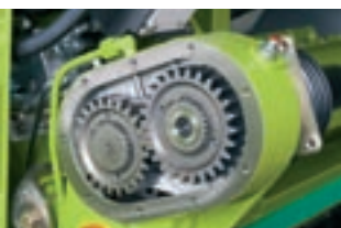
Zahnradwechsel zur Drehzahlanpassung.
