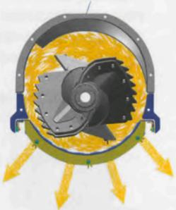
Ferner verfügt der LEXION 600 über elektrisch verstellbare Lamellen zur variablen Anpassung der Rotorabscheidefläche. Komfortabel von der Kabine aus reduzieren Sie schrittweise die offene Abscheidefläche der Rotorkörbe und damit die für die Reinigung anfallende Spreumenge. Die variable Veränderung der Rotorabscheidefläche gewährleistet unter allen Einsatzverhältnissen eine maximale Restkornabscheidung.
