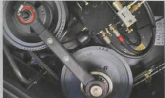
Ein Variator für den Pflückerantrieb sorgt für eine optimale Anpassung der Pflückgeschwindigkeit an die Vorfahrtsgeschwindigkeit.
