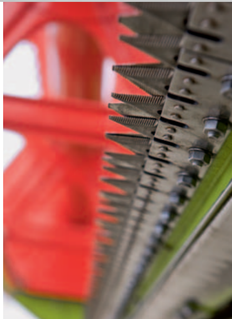
Abweiser als Wickelschutz
