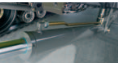
2-Wege-Schneidwerkszylinder regeln präzise den Auflagedruck.
