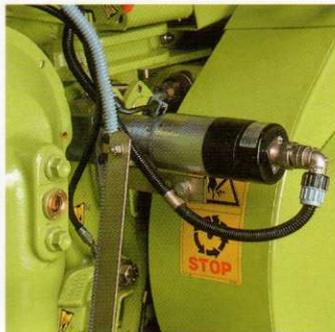
Messerschärfe und „Spalt“ sind so in kürzester Zeit optimal elektrohydraulisch eingestellt.
