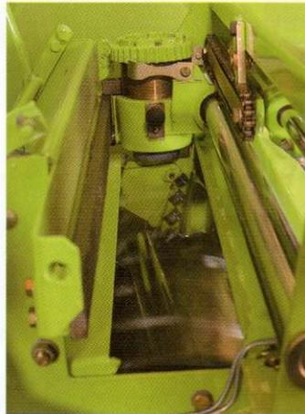
Das Einzugsgehäuse kann – nach bewährter CLAAS-Manier – in Sekundenschnelle ohne großen Aufwand vom Trommelgehäuse abgeklappt werden. So haben Sie blitzschnell volle Sicht auf die Gegenschneide und die Häckseltrommel. Nur so können Sie Messer und Gegenschneide klar und schnell sehen.
