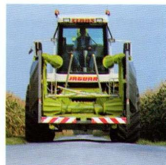
Schneller Einsatzortwechsel mit angebautem RU-450-Vorsatz – Transportbreite unter 3 m. Hydraulisch vom Fahrersitz aus stellen Sie von Arbeits- auf Transportstellung um. Die äußeren Arbeitseinheiten schwenken hoch, und Sie brauchen für die Straßenfahrt nur noch die Spitzen abzudecken.
