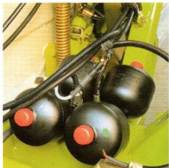
Das Geheimnis von CLAAS-Contour sind „flexible“ Stickstoffblasen. Mehr oder weniger prall gefüllt – elektrohydraulisch gesteuert, je nach Geländestruktur – „tragen“ sie den Vorsatz ohne nennenswerten Auflagedruck über die Einsatzfläche.
