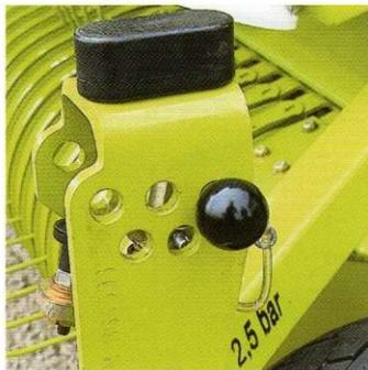
In 5 Stufen einstellbare, großvolumige Tasträder übernehmen die Bodenföhrung. An den Achsen und an dem Tragarm befindet sich eine Schwenkeinrichtung.
