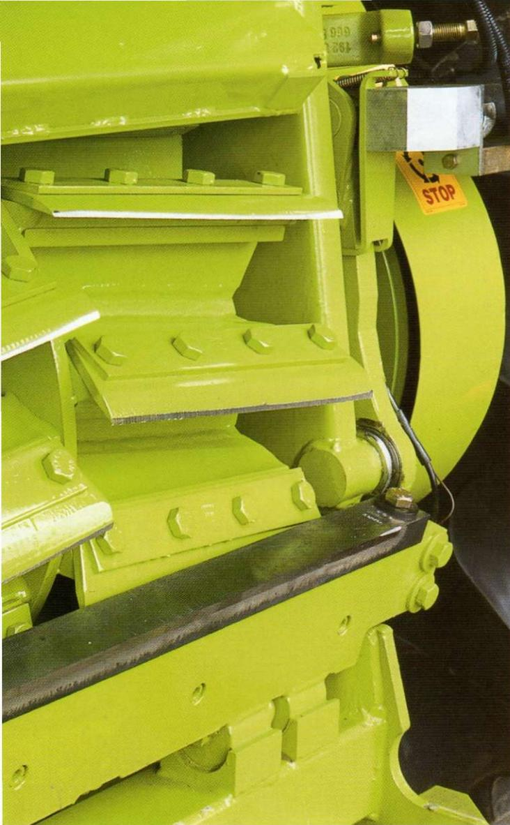
Stark die Kraftübertragung vom Motor zur Häckseltrommel und zum Beschleuniger. Sie erfolgt direkt. Ein einziges robustes, permanent gespanntes 5- bis 7rilliges Powerband sorgt für optimalen Durchzug. Mit der Nieder-
