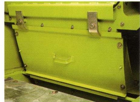
Für die Ernte von Anwelgrassilage ersetzen Sie den Corn-Cracker durch einen Grasschacht. Die Rückwand des Grasschachtes ist abnehmbar und erleichtert die Zugänglichkeit zum Beschleuniger, dessen Rückwand als separates Verschleißteil ausgelegt ist.
