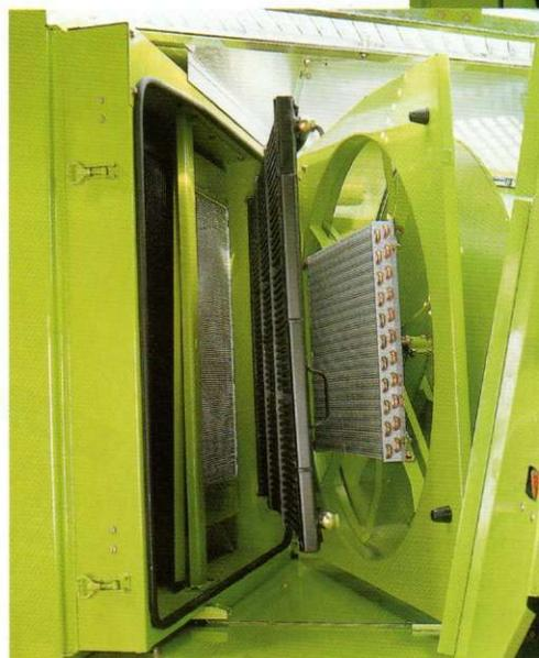
frischer, reiner Luft – angesaugt dort, wo sie am saubersten ist: hinter der Kabine. Die erwärmte Abluft, auch Feinststaub und der Schall verlassen die Maschine nach hinten. Die Vorteile: keine zusätzliche Belastung des Maschinenführers und – ganz wesentlich – eine volle Saison lang nahezu wartungsfrei.
