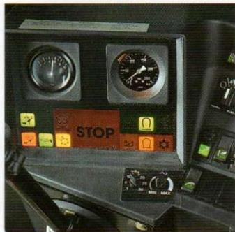
Noch bequemer läßt sich die elektrische Gegenschneide aus der Kabine heraus justieren. Über einfache Drehschalter wählen Sie die Anzahl der Schleifintervalle und bestimmen den genauen Abstand der Messer zur Gegenschneide.
