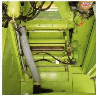
Wollen Sie Anwelkgras-silage ernten, ersetzen Sie den Corn-Cracker durch einen Grasschacht. In Minutenschnelle ist der Wechsel perfekt: Corn-Cracker einfach nach hinten aus dem Auswurfschacht rollen und arretieren, Grasschacht einsetzen
