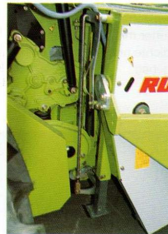
Erst Gras und gleich im Anschluß Mais beispielsweise – dank der Zentralverriegelung des Vorsatzes ein „fliegender“ Wechsel.
