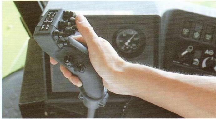
Bequem und griffgünstig der CLAAS-Multifunktionsgriff. Mit ihm hat der Fahrer den Häcksler voll im Griff. Die unterschiedlichsten Funktionen sind hier zusammengefaßt: Vorwärts-Rückwärtsfahrt, Fahrgeschwindigkeit, Vorsatzgerät heben/senken, Absenkautomatik und Auflage- druck aktivieren, Einzug ein/aus/reversieren und Auswurfklappenstellung. Der Maschinenführer braucht nicht lange nach Schaltern und Hebeln zu suchen, er regelt alles mit einer Hand. So wird Leistung dirigiert.
