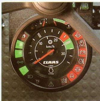
Der Fahrinformator – direkt unter dem Lenkrad im Blickfeld des Maschinenführers – informiert über alle Fahrfunktionen, unter anderem über Fahr- geschwindigkeit, Motor- temperatur, Motoröldruck, Batterieladung, Kraftstoff- vorrat.
