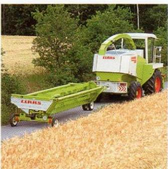
**Vorteile:** gleichmäßiger Schnitt, sauberes Futter, kontinuierliche Beschickung der Messertrommel. Mit dem angehängten Transportwagen sichere Fahrt zum Einsatzort.
