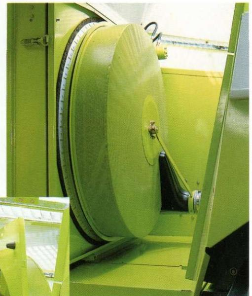
Hervorragend geregelt ist die Zugänglichkeit zu den Kühlaggregaten. Schnell und einfach kommen Sie an den Ölkühler, die Kühlelemente für die Klimaanlage, den grobmaschigen Wasser- und Luftkühler heran. Kühlerkorb öffnen und beiseite schwenken – das ist so quasi schon alles. So praxisorientiert sieht Wartungsfreundlichkeit bei CLAAS aus.
