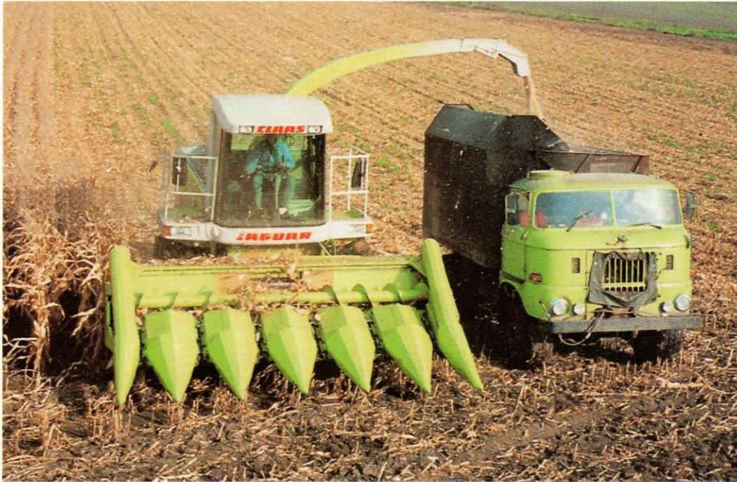
Maiskolbenschrot (LKS) ernten diese großen JAGUAR-Feldhäcksler mit dem Maispflücker. In einem Arbeitsgang wird der gesamte Maiskolben gepflückt und gleich geschrotet. LKS ist ein hochwertiges Kraftfutter mit hoher Energiekonzentration und wird vorwiegend in der Rinderhaltung zur Milch- und Fleischerzeugung eingesetzt.
