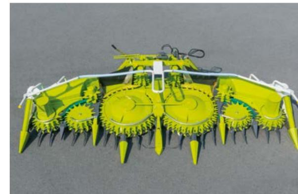
Das ORBIS 600 SD wird parallel zum ORBIS 600 angeboten und eignet sich besonders für normale und kleinwüchsige Bestände. Die Außeneinheiten mit den kleinen Scheiben und den zusätzlichen vertikalen Fördertrömmel ermöglichen einen extrem guten Gutfluss. Zudem ist ein sehr kurzer Stoppschnitt möglich.
