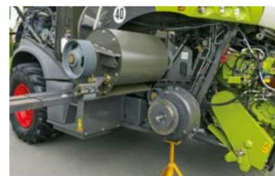
Unkomplizierter und schneller Aus- und Einbau des Beschleunigers
