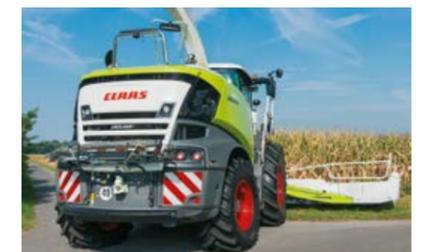
Optional: praktische Ablage zur Mitnahme der Schutzeinrichtung für den Vorsatz während des Ernteeinsatzes
