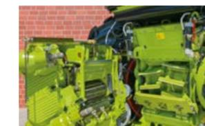
QUICK ACCESS: schneller Zugang zur V-MAX Messertrommel
