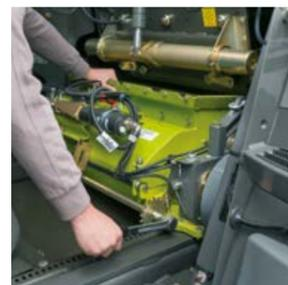
Schneller Aus- und Einbau des Corncracker
