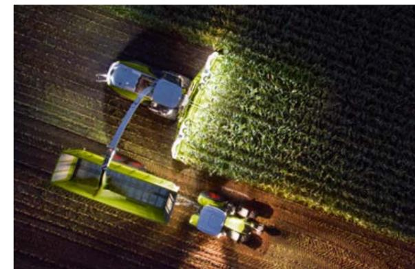
AUTO FILL. Automatische Steuerung des Auswurfkrümmers. Jetzt auch mit Hecküberladung.
